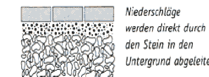
ÖKOPFLASTER 20 x 20cm - Kanten leicht gefast - Fugenbreite 4 mm - mit Filtervorbereitungsschicht
